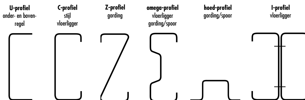
33. Doorsnedes van koudgevormde profielen voor de woningbouw.
