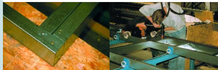
afb. 5.14 Het uiterlijk van een clinchverbinding.
